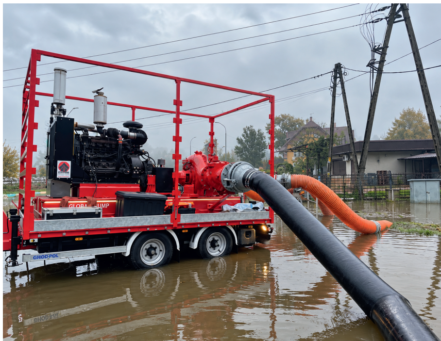
Rys. 7. Wypompowywanie wody z zalanych obszarów przy pomocy pompy o wydajności 45000 l/min.
